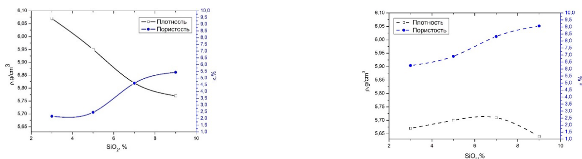
Рис. 2. Плотность и пористость исследованных керамических образцов: сплошная – до облучения, пунктирная – после облучения.
