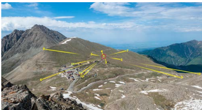
Рис. 1. Установка Горизонт-T: 13 пунктов регистрации, высота над уровнем моря – 3350 м.
